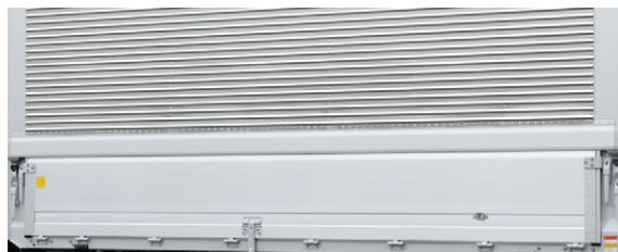
2 ウイング部 アルミコルゲート アオリ部 段付アルミブロック
