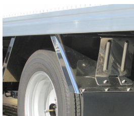
111 リヤフェンダー ステンレス製に変更
