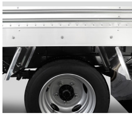
110 リヤフェンダー ステンレス製に変更
