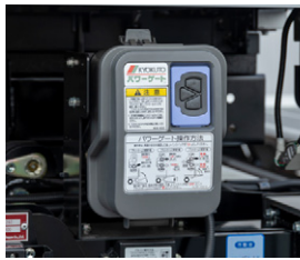
84 スイングアーム式リフト装備 庫外リモコンスイッチ追加 （左：庫外リモコンスイッチ樹脂製スイッチボックス、右：庫外リモコンスイッチ本体）
