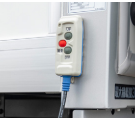
84 スイングアーム式リフト装備 庫外リモコンスイッチ追加 （左：庫外リモコンスイッチ樹脂製スイッチボックス、右：庫外リモコンスイッチ本体）
