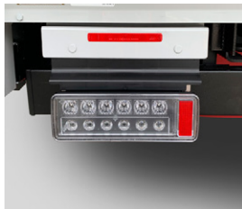
76 吊下式テールランプを LEDに変更
