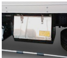
65 工具箱 ステンレス製に交換
