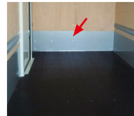
33 荷室ガードフロント・サイド三方 下部スチール製
