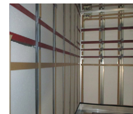
61 断熱材フロント・サイド・ルーフ スチロフォーム
