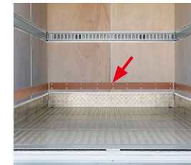
35 荷室ガードフロント・サイド三方 樹脂製
