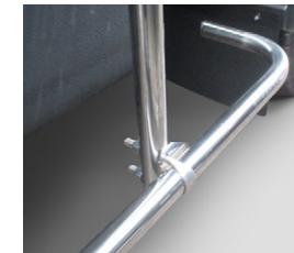
108 サイドバンパー ステンレス製丸パイプ2段に変更
