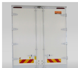
4 アルミ型材バックドア 外板白色
