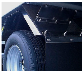
64 リヤフェンダー ステンレス製に変更
