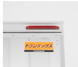
78 後部トップマーカーランプを 赤色LEDストップランプ兼用タイプに変更
