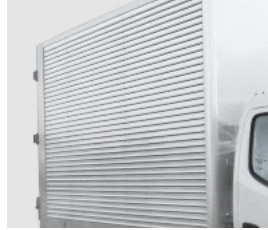
4 外板アルミコルゲート[波板]
