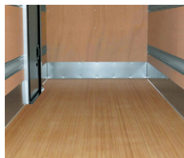
59 荷室ガードフロント・サイド三方 スチール製
