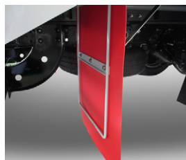
61 泥除け 後端左右に取付
