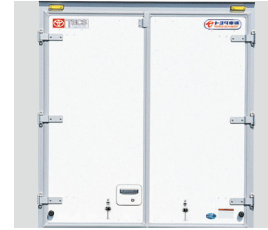
6 ワンタッチ式左先開きバックドア ※スマーティは標準装備
