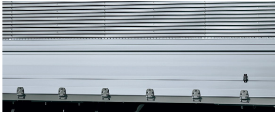
8 外板アオリ アルミ押し出し材 高さ:500mm
