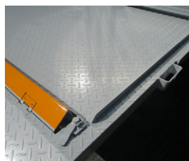
123 スイングアーム式リフト装備 プラットホーム サイドストッパー追加
