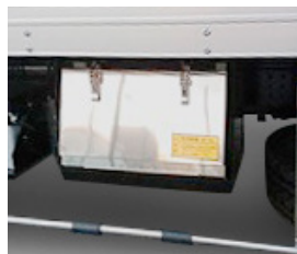
65 工具箱 ステンレス製に交換
