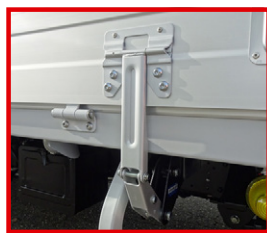
2 ウイング部 アルミコルゲート アオリ部 段付アルミブロック
