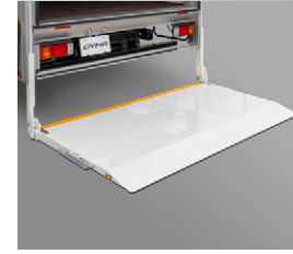
76 垂直式リフト装備 表面平銅板張り ※パレット車は標準装備
