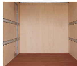
41 内張り耐水合板 【フロント・サイド】
