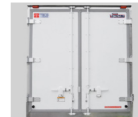
11 サンドイッチ構造 バックドア
