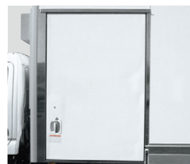
35 ワンタッチスライド式サイドドア ドア枠ステンレスタイプ
