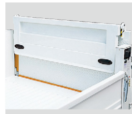
18 プラットホーム2段折れ
