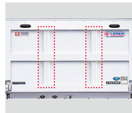
17 プラットホーム裏面補強
