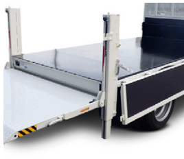
2 フロア鋼板張り
