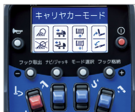
56 クレーンラジコンで 車載作業操作
