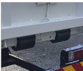
86 ボディ後端ローラー2個追加 ※写真はオプションの樹脂製。
