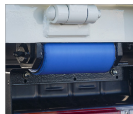
37 荷台設置ローラー(樹脂製)
