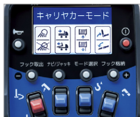
56 クレーンラジコンで 車載作業操作
