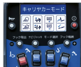
57 クレーンラジコンで 車載作業操作
