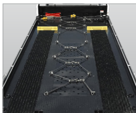
11 タイヤ通行部分 (エキスパンドメタル張り)
