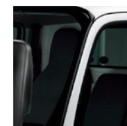
ピラーがあることにより、右目と左目に見えない範囲が生じます。ワイドビューピラーでは左右両視線で見ることにより、従来に比べ死角が少なくなり、運転席からのより確かな視界が確保できます。
