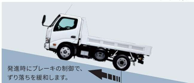
発進時にブレーキの制御で、ずり落ちを緩和します。
