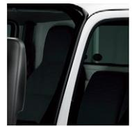
ピラーがあることにより、右目と左目に見えない範囲が生じます。ワイドビューピラーでは左右両視線で見ることにより、従来に比べ死角が少なくなり、運転席からのより確かな視界が確保できます。
