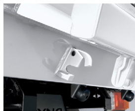
④ リヤゲート自動開閉装置 全車
