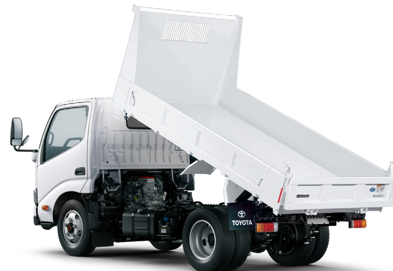
写真および図面は10尺デッキ・4WD・フルジャストロー・2.0トン積。 ボディカラーはホワイト(058)(鳥居:Aタイプ)。車型番号 4
