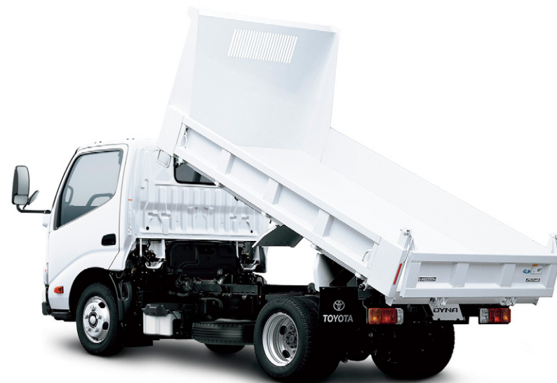
写真および図面は10尺デッキ・2WD・フルジャストロー・2.0トン積。 ボディカラーはホワイト(058)(鳥居:Aタイプ)。車型番号 1
