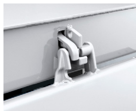
③ リヤゲート落下防止装置 全車
