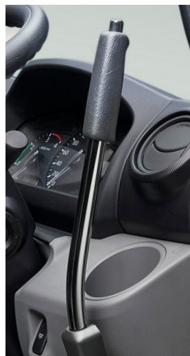
① PTO連動式ダンプレバー 全車
