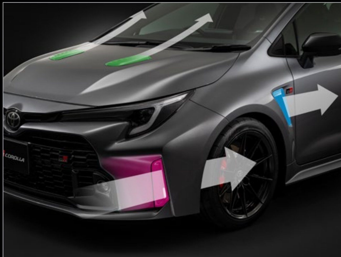
フロント ■ フードダクト（ダウンフォース向上、操安性向上） ■ フロントバンパーダクト（ドラッグ低減、操安性向上） ■ フェンダーダクト（操安性向上）
