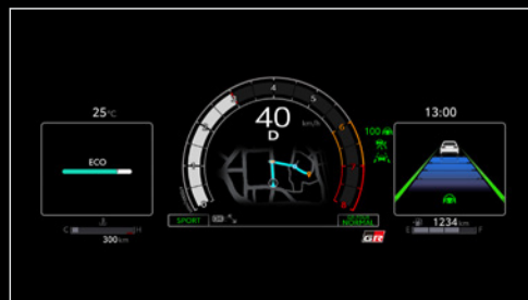
1眼タコリング表示 中央:ナビ地図 左:エコバー 右:走行支援
