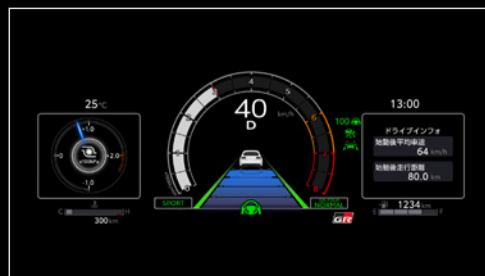
1眼タコリング表示 中央:走行支援 左:ブースト計 右:ドライブインフォメーション
