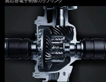
高応答電子制御カッピング
