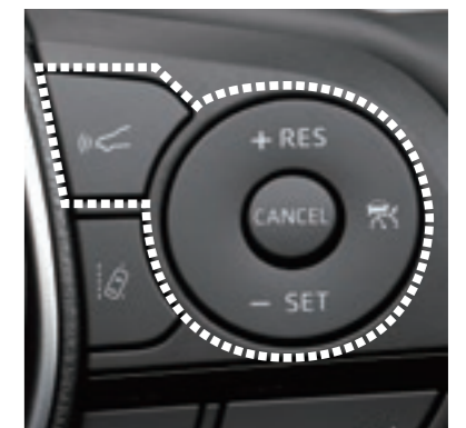
レーダークルーズコントロール/ 車間距離切替スイッチ
