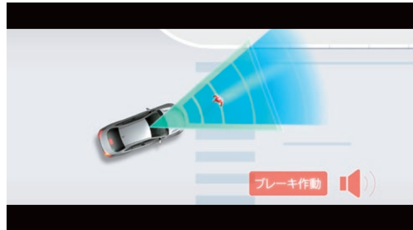
[自車右左折時、対向方向から横断してきた歩行者を検知。]
