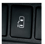
パワースライドドアスイッチ (インストールメントパネル部)
