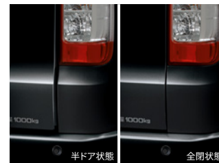
■ イージークローザー (スライドドア・バックドア) 写真はバックドア
