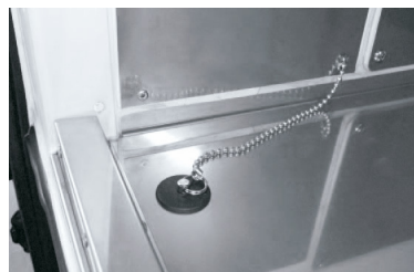
⑰ フロアサイド水止め&水抜き穴追加(前左側) サイドドア部に25mmの水止めを設置し、水抜き穴を追加します。
