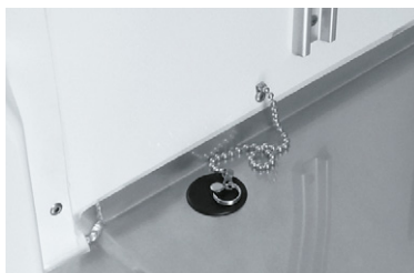
⑭ 水抜き穴追加(後左側)
