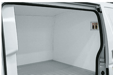
㉒ 荷室内間仕切り(固定式) 荷室内を仕切ること、荷物の積み分けができます。 床面長さ:前室1,335mm、後室1,315mm (ジャストローは1,320mm)。
