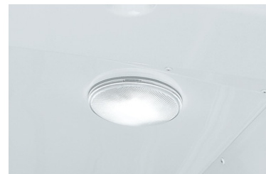
⑮ 庫内ルームランプ(白熱灯) バックドア開口部右側に取り付け。
