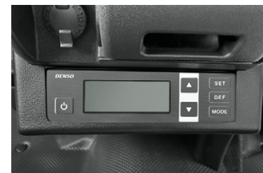
㉕ コントロールパネル移設 ナビゲーションシステム等で、大型センターポケット 全体を使用する場合は必ず選択ください。 (注) 足元スペースが狭くなります。
