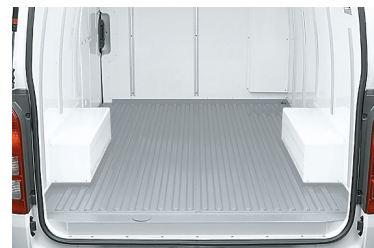
⑨ フロア材 亜鉛引き鋼板キーストン キーストン形状により冷気の循環性を高めます。
