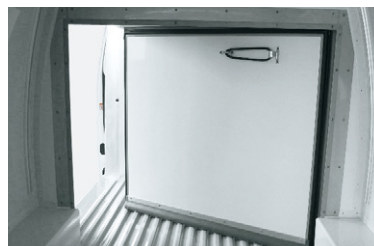
㉓ 荷室内間仕切り(開閉式) 積荷の量や用途に応じて、荷室を変更できます。 前方から1,280mmに取り付け(前開き)、 ハンドルにて開閉でき簡易固定が可能です。
