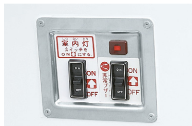
㉑ 非常警報装置 万一、庫内に閉じこめられた場合に、外部に知らせることができます。 (荷室内右側面後側に設置)
