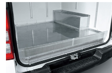
㉖ エアダム(バックドア用) バックドア下部からの冷気の流出を抑えます。
