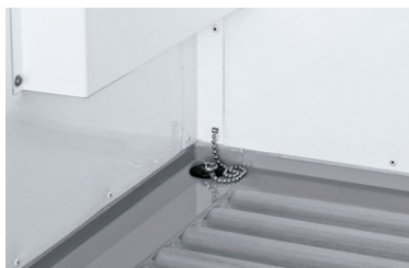
⑬ 水抜き穴(前右側)
