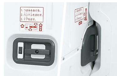
㉒ 非常ハンドル 非常時、荷室内からバックドア、スライドドアを開けることができます。 ※低温冷凍バンには設定がありません。
