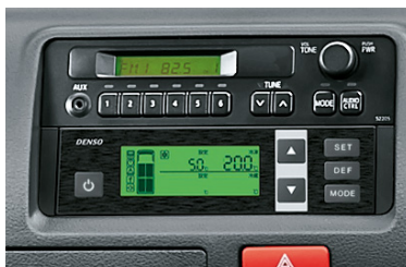
⑳ 冷凍機(コントロールパネル) オーディオ下部に設置。 (写真のAM/FMはメーカーオプション)
