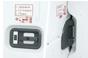
③③ 非常ハンドル 非常時、荷室内からバックドア、スライドドアを開けることができます。 ※低温冷凍バンには設定がありません。
