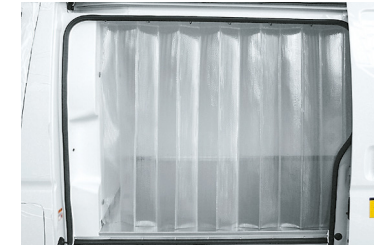
⑦ カーテン(サイドドア用) サイドドア開放時に冷気の流出を抑えます。
