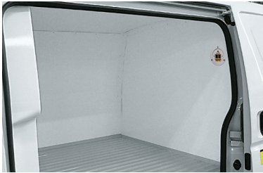
㉔ 荷室内間仕切り (固定式) 荷室内を仕切ること、荷物の積み分けができます。 床面長さ: 前室1,335mm、後室1,315mm (ジャストローは1,320mm)。
