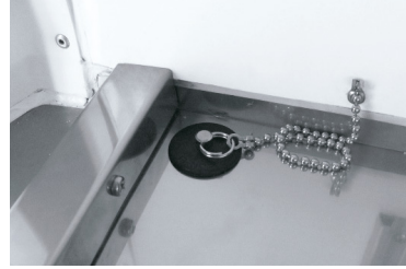
⑲ フロア後部水止め&水抜き穴追加 (後左側) バックドア部に25mmの水止めを設置し、左側に水抜き穴を追加します。
