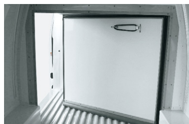
㉕ 荷室内間仕切り(開閉式) 積荷の量や用途に応じて、荷室を変更できます。 前方から1,280mmに取り付け(前開き)、 ハンドルにて開閉でき簡易固定が可能です。
