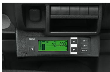
⑳ 冷凍機(コントロールパネル) (注)中央席の足元スペースが狭くなります。
