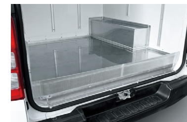
⑧ エアダム(バックドア用) バックドア下部からの冷気の流出を抑えます。
