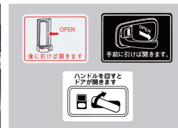
㉙ 扉開放表示ラベル
