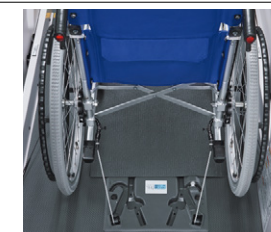
e: 後側ワイヤー式/電動(リフト上) ※サポートバーは装着されません。
