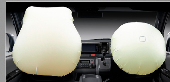
■ SRS*エアバッグ+プリテンショナー&フォースリミッター機構付シートベルト(助手席) *SRS(乗員保護補助装置): Supplemental Restraint System
