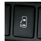
パワースライドドアスイッチ (インストルメントパネル部)
