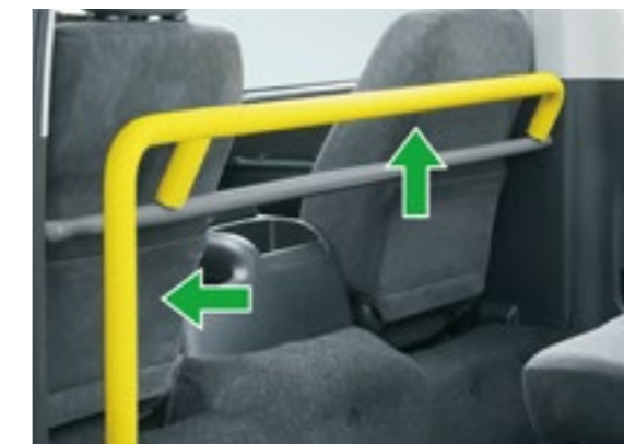
⑭ フロントハンドレール & スライドドア乗降口ハンドレール
