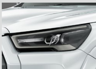
■ Bi-Beam LED ヘッドランプ (オートレベリング機能・専用加飾付)
