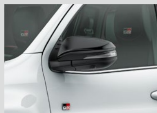
■ サイドターンランプ付電動格納式 ドアミラー (ブラック塗装)
