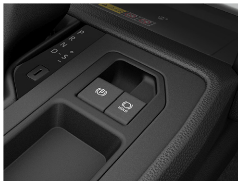
左:電動パーキングブレーキスイッチ 右:ブレーキホールドスイッチ
