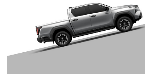
制御あり。発進時にブレーキの制御でずり落ちを緩和します。
