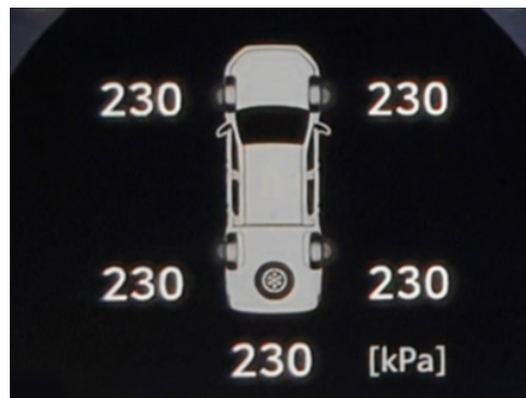
各タイヤの空気圧 (表示例)
