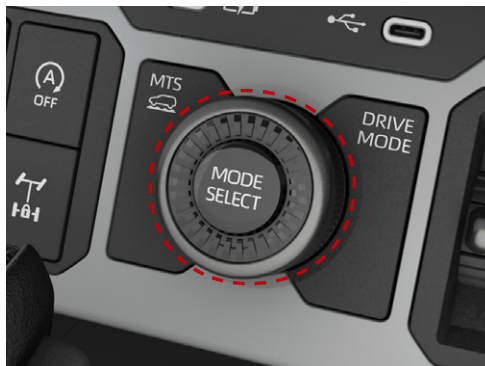
モードセレクトスイッチ ■写真はZ。
