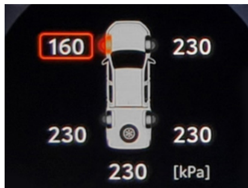
低空気圧警報時 (表示例)
