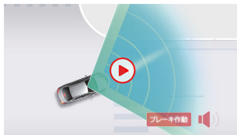
[自車右左折時、横断してきた歩行者や自転車も検知。]
