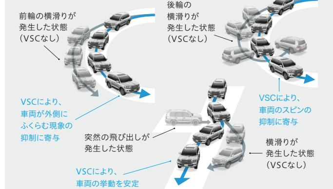
車両状態・路面状況ごとに適切にブレーキを制御。
