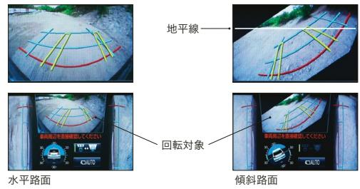
■アンダーフロアビューは道路状況、車両状態および天候状態等によって車両位置やタイヤ位置を示す線がずれたり、作動しない場合があります。詳しくは取扱書をご覧ください。 ■フロントビュー回転表示は、実際の車両の傾きとフロントビューの傾きが異なる場合があります(回転角度はあくまで目安です)。 ■フロントビューの回転によって、フロント左右バンパー端付近の映像が見えなくなることがあります。
