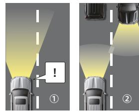
■自車速度約30km/h以上で作動します。
