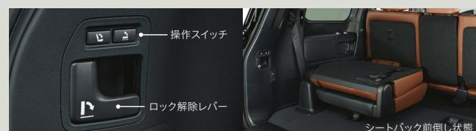
スイッチ [▲] を押すとヘッドレスト、シートバックが倒れ、続けてシートが跳ね上がり、
