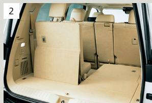
シートバックが格納している最中に、クッションも自動で動き出す。
