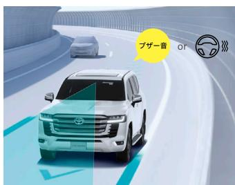
車線をはみ出しそうなときは、ブザーまたはステアリングの振動\*3&ディスプレイ表示に加え、逸脱しようとする方向と反対側の車輪に制動力を加えヨー(クルマを回転させる力)を発生させ、逸脱抑制を支援。白線だけでなく、アスファルトや縁石などの境界から逸脱すると判定した場合も支援します。
