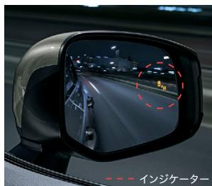
隣接する車線の最大約60m後方までモニターし、急接近してくる車両も検知。ドアミラーのインジケーターによって車両の存在をお知らせするだけでなく、車両を検知した状態でウインカー操作をするとインジケーターが点滅してより注意喚起します。また、後方車両から衝突される可能性が高いと判断した場合、ハザードランプを高速点滅させて、後方車両に注意喚起する後方車両への接近警報や、停車中に開いたドアに後方車両(自転車も含む)が衝突する可能性が高いと判断した場合、ドアミラーのインジケーターとブザーによって注意喚起する停車時警報<sup>\*2</sup>も搭載しています。
