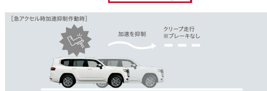
■ブレーキを制御するシステムではありません。 ■自車車速約30km/h 以下で作動します。 ■前進および後退時に作動します。 ■アクセルを強く踏み込むような運転をした時に、意図せずシステムが作動することがあります。
