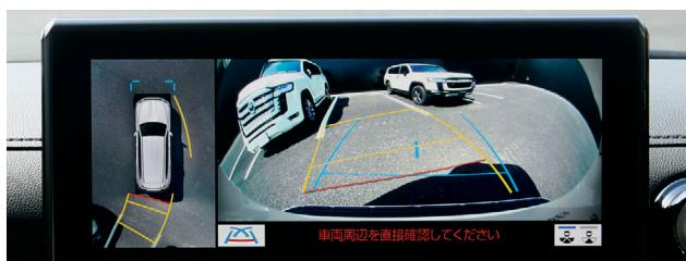
車両を上から見たような映像をディスプレイオーディオもしくはナビ画面に表示。運転席からの目視だけでは見にくい、車両周辺の状況をリアルタイムでしっかりと確認できます。さらにクルマを透かして外を見るような映像で周辺を確認できるシースルービューや、車両を後ろ上方から見たような映像を表示し、車両側方の安全確認ができるサイドクリアランスビュー、狭い道での接触回避を確認できるコーナリングビューも採用。また、クリアな視界を保つため、バックカメラにはカメラ洗浄機能<sup>\*4</sup>が付いています。
