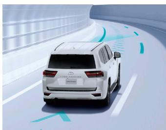
車線の中央を走行するために必要なステアリング操作の一部を支援\*2。渋滞時など白線(黄線)が見えにくい、または見えない場合も、先行車を追従してステアリング操作を支援します。
