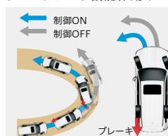
※トランスマニュアルギヤ位置:L4、クロールコントロール作動時のみ作動します。
