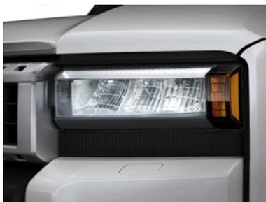
リフレクター式3眼LEDヘッドランプ(オートレベリング機能付) + LEDクリアランスランプ(おむかえ照明機能付) & LEDデイトタイムランニングランプ
