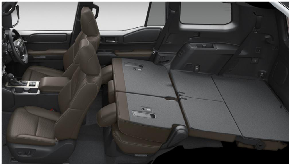
セカンドシート前倒し+サードシート両側フロア格納状態
