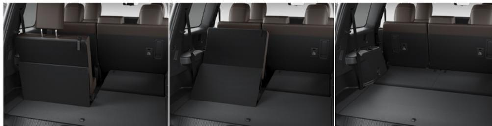
格納スイッチを一度押すと、シートバックが垂直位置まで移動。
