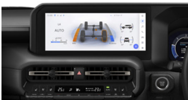
マルチセレインセレクト表示画面 (デフロックのオン/オフ状態を表示)
