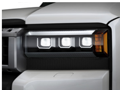
プロジェクター式3眼LEDヘッドランプ(オートレベリング機能付)+LEDクリアランスランプ(おむかえ照明機能付)&LEDデイトタイムランニングランプ
