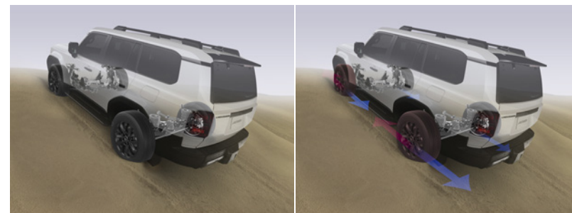
クローラコントロールシステム作動イメージ(スタック状態からの後退脱出)
