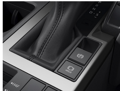
上:電動パーキングブレーキスイッチ
