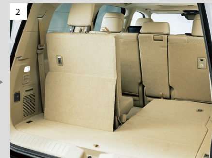
シートバックが格納している最中に、クッションも自動で動き出す。
