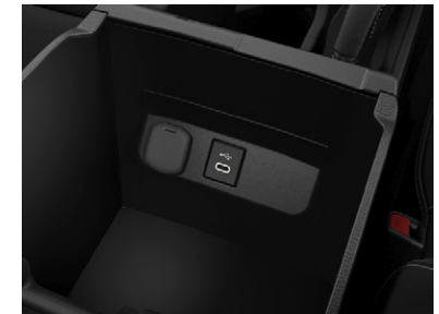
① アクセサリーソケット (DC12V・120W/ センターコンソールボックス内1個) & 通信用USB端子 (Type-C/ センターコンソールボックス内1個)
