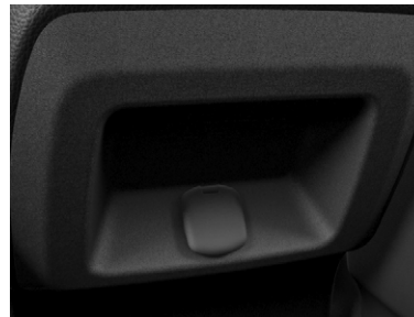
⑥ アクセサリーソケット (DC12V・120W/ センターコンソールボックス背面1個)
