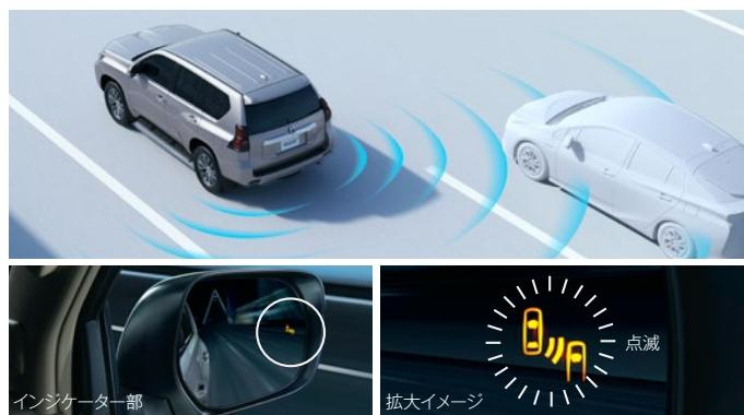
後方から接近する車両を検知して、衝突被害の軽減に寄与。
