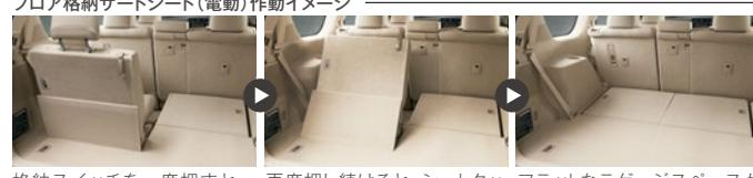
格納スイッチを一度押すと、シートバックが垂直位置まで移動。
