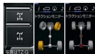
電動センターデフロックスイッチ & 4輪トラクション作動表示例
