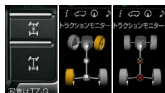
電動センター 4輪トラクション デフロック作動表示例
