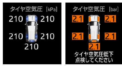
各タイヤの空気圧(表示例) 低空気圧警報時(表示例)
