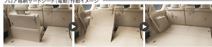
格納スイッチを一度押すと、シートバックが垂直位置まで移動。
