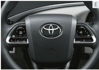
ステアリングスイッチ (ディスプレイ切替く4方向スイッチ・オーディオ・音声認識・ハンズフリー・車間距離切替・レーンディパーチャアラート)
