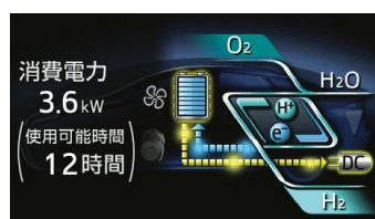
給電モニター
