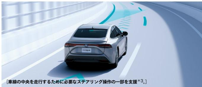
渋滞時など白線(黄線)が見えにくい、または見えない場合も、先行車を追従してステアリング操作を支援します。
