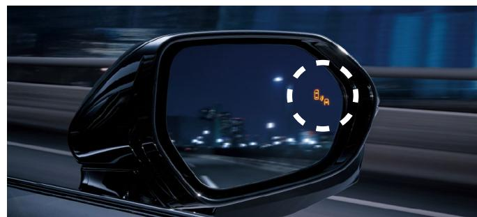
■ BSM : Blind Spot Monitor ■検知対象の目安となる大きさは、小型の二輪車よりも大きな車両となります。一部の特殊な道路状況等では、静止物に対してもインジケーターが点灯する場合があります。 ■天候状態、道路状況、および車両状態によっては、ご利用になれない場合があります。 ■ブラインドスポットモニターは、車線変更時の後方確認アシストするシステムです。実際の車線変更時にはドライバー自ら周囲の安全状況を直接確認する必要があります。
