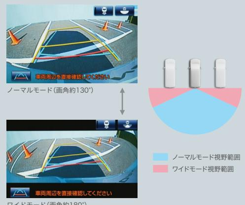
車庫入れの際、後退操作の参考になるガイドラインをモニターに表示します。バックカメラの画角を約180°までワイド化することで視野範囲を広げ、サードシート跳ね上げ時も、より良好な後方視界を確保します。画面内のスイッチ操作によりノーマル↔ワイドモードの切替も可能です。
