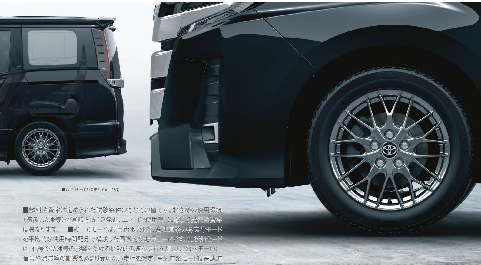
■HYBRID Si専用16インチ鍛造アルミホイール(BBS製)
