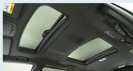
フロント側は手動でチルト、リヤ側は電動でルーフの開閉が可能。挟み込み防止機能<sup>7</sup>も備えています。
