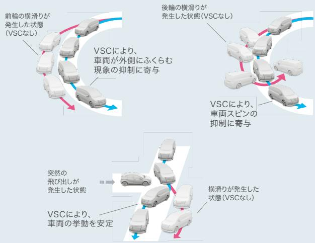
S-VSC<sup>\*1</sup>はステアリング制御(EPS<sup>\*2</sup>)、ブレーキ制御(VSC<sup>\*3</sup>、ABS<sup>\*4</sup>)、駆動力制御(VSC、TRC<sup>\*5</sup>)を協調して制御します。例えば、滑りやすい路面でのコーナリング時などに、車両の挙動が安定する方向に操舵トルクをアシスト。優れた操縦性と走行安定性を実現します。
