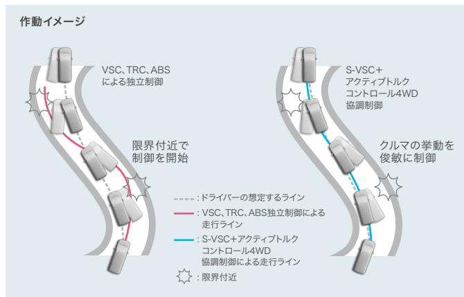
S-VSC<ステアリング制御(EPS)、ブレーキ制御(VSC、ABS)、駆動力制御(VSC、TRC)>と4WD制御が互いに協調し合い、制御を行うことで、滑りやすい状況下でもドライ路面でも優れた車両安定性を確保します。
