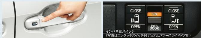
ワンタッチで簡単に開閉できるスイッチを採用。スマートエントリーシステム＋プッシュスタートシステム装着車の場合、スマートキーを携帯していればワンタッチスイッチを押すだけで解錠＆ドアオープンすることもでき、買い物で手荷物を抱えている時などに便利です。挟み込み防止機能<sup>※1</sup>も備えています。
