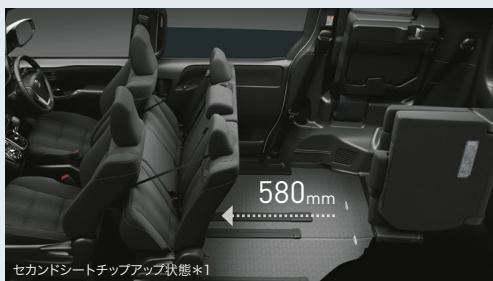
\*1.6:4分割チップアップシートの左席はシートバック前倒し連動チップアップとなり、右席は手動でのチップアップとなります。
