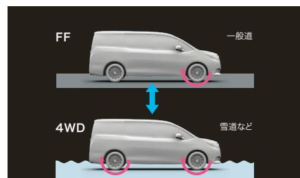
前輪駆動状態と4輪駆動状態を自動的に電子制御します。通常の走行時には、前輪駆動状態で燃費効率の良い走りを実現。発進・加速時や滑りやすい路面、コーナリング時には、車両の状態に合わせて最適な駆動力を後輪に配分します。
