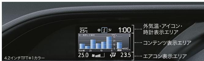
走行中の視線移動を少なくし、乗乗者との情報共有も可能にするためにインパネ中央にマルチインフォメーションディスプレイを配置。大型液晶を活かした充実のコンテンツを表示します。またハイブリッド車は、ハイブリッドシステムの作動状態なども分かりやすく表示。なお、ステアリングスイッチで表示切替を行います。
