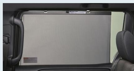
スライドドアのトリム内に、サンシェードを設定。直射日光を遮り、後席の方に快適なひとときを提供します。なお、サンシェードではカバーできないウインドウ両端にも遮光性を持たせることで、窓全面をしっかりと遮光します。
