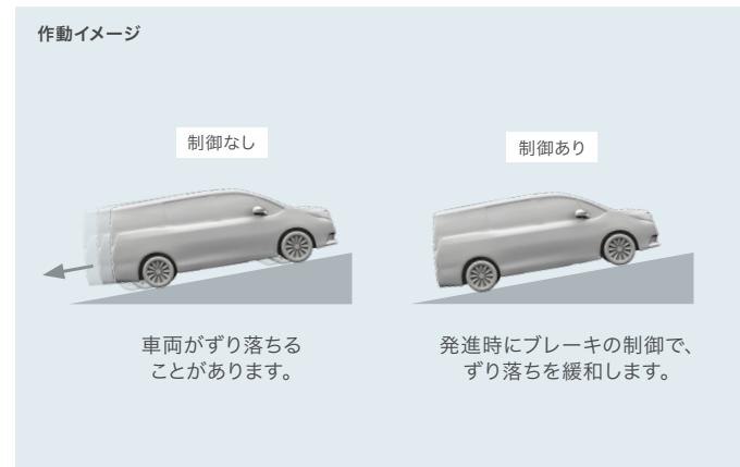
坂道での発進時、ブレーキからアクセルに踏み替える際に、ブレーキ油圧を保持することによって車両のずり落ちを緩和し、スムーズな発進を実現します。
