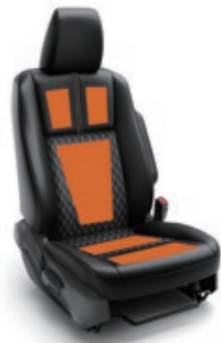
オレンジは、ヒーター加温箇所
