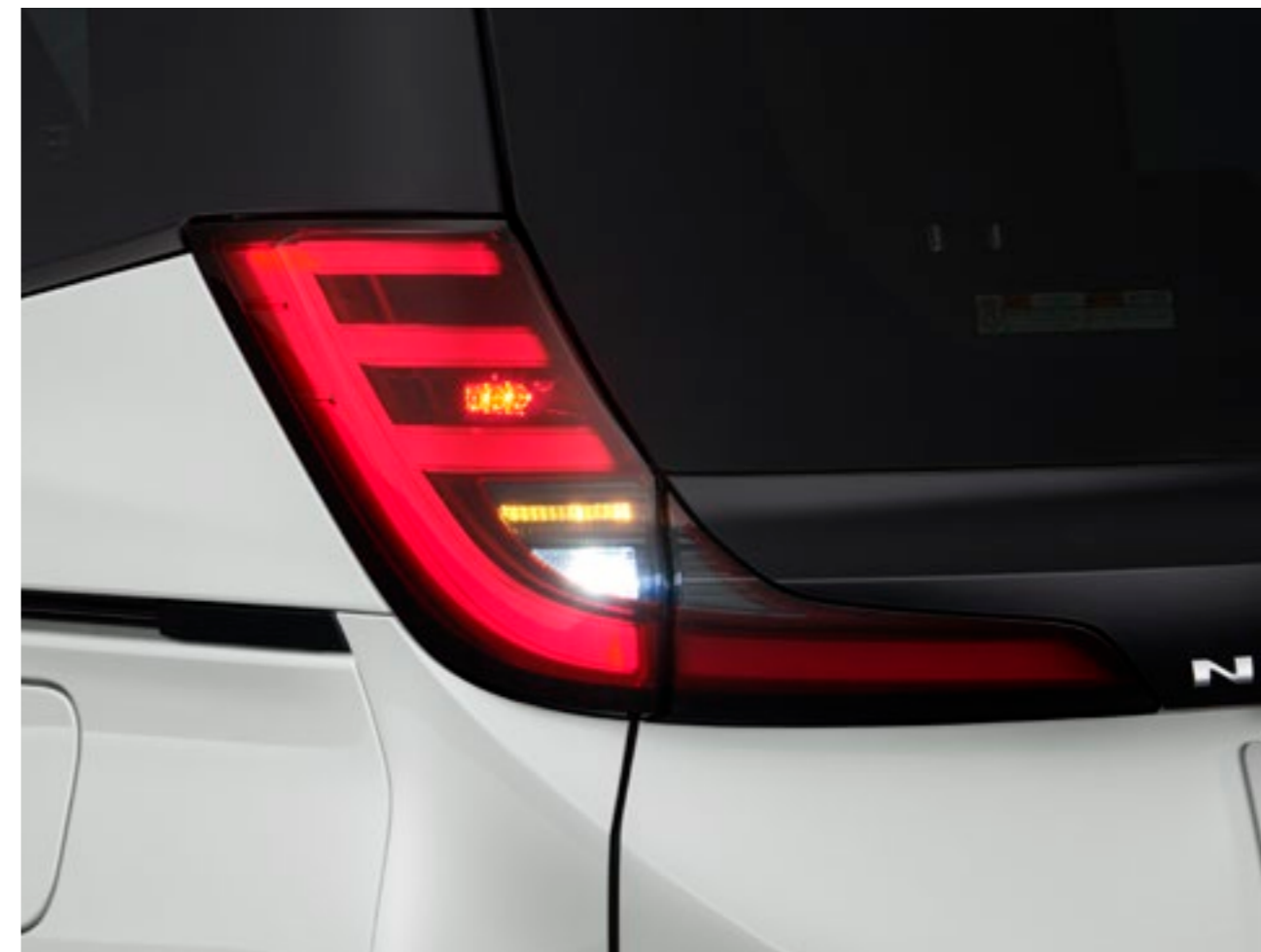
リヤコンビネーションランプ (LEDストップランプ+LEDテールランプ+LEDターンランプ+LEDバックアップランプ)
