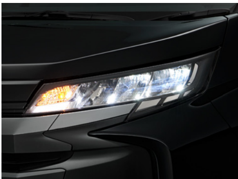
リフレクター式LEDヘッドランプ(マニュアルレベリング機能付) +LEDクリアランスランプ+ターンランプ
