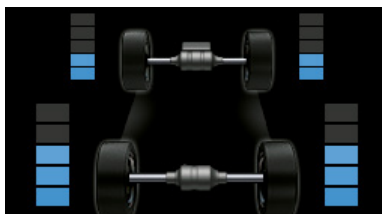
マルチインフォメーションディスプレイ内の前後輪トルク分量表示
