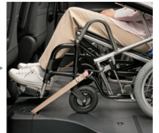
⑤フロアのガイドラインを目安にセカンド席まで進み、車いすの後輪中央を床面の停止線に合わせ停止します。セーフティベルトにより、車いすの前側が固定されます。
