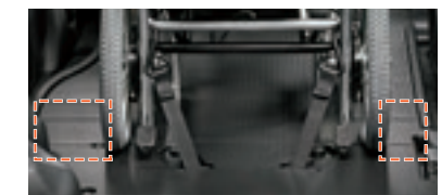
⑤フロアのガイドラインを目安にセカンド席まで進み、車いすの後輪中央を床面の停止線に合わせ停止します。セーフティベルトにより、車いすの前側が固定されます。
