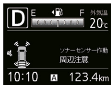
コーナーセンサー作動表示 (TFTマルチインフォメーションディスプレイ*1*2)
