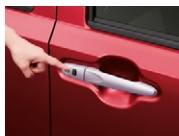
スイッチ操作でドアの施錠・解錠
