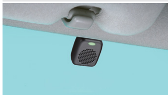
ETCアンテナ装着例
