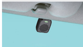
ETCアンテナ装着例
