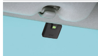
ETCアンテナ装着例
